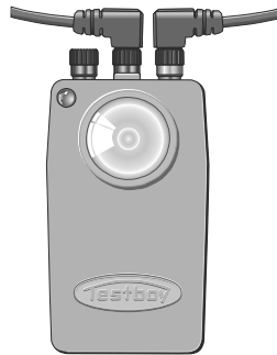
Měření průchodu žárovkou
