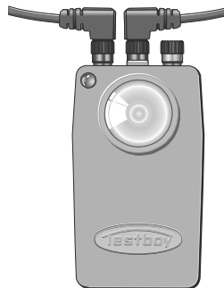
Měření průchodu pomocí bzučáku
