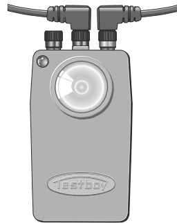
Prove della continuità con lampada ad incandescenza
